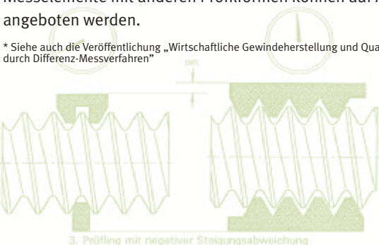
3. Prüfling mit negativer Steigungsabweichung
